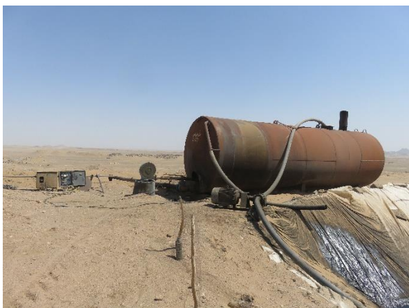
شکل ۲-۱۱- نمایش از کمپ حرارتی (سمت راست تانکر مجهز به کوره و سمت چپ تانکر مستقر شده در نزدیکی استخر ذخیره مالچ)
