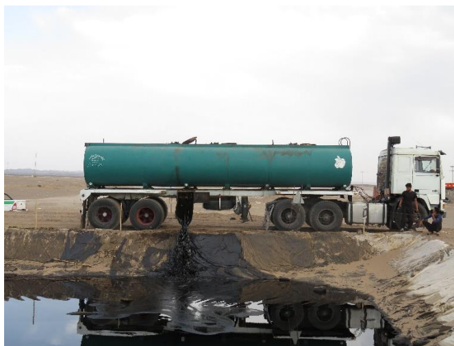
شکل ۲-۱۴- استخر ذخیره مالچ و نحوه تخلیه مالچ از کامیون به داخل آن
