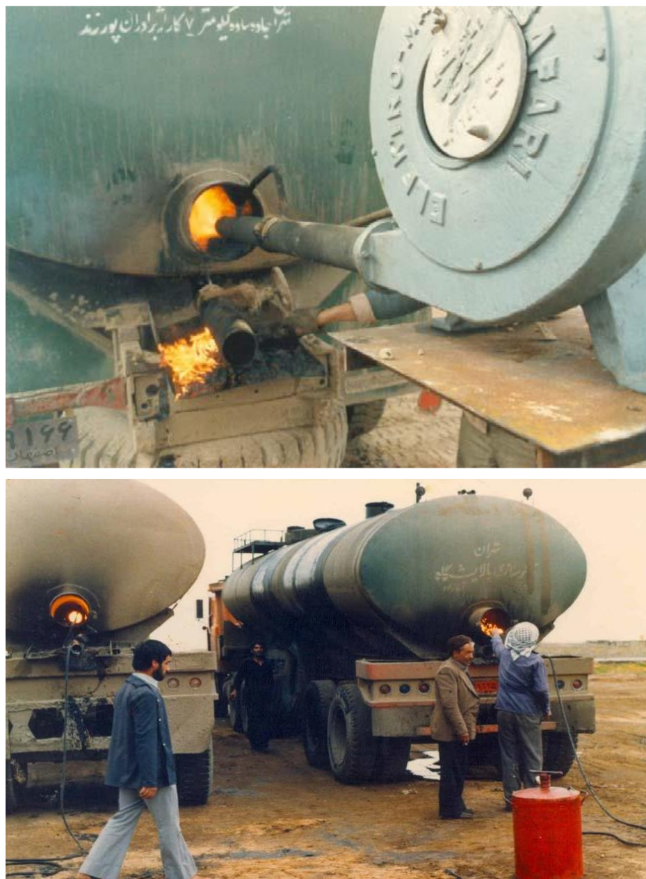
شکل ۲-۳۴- برای گرم کردن مالچ در کمپ تخلیه، شکل‌های مختلفی از مشعل مورد استفاده قرار می‌گیرد.
