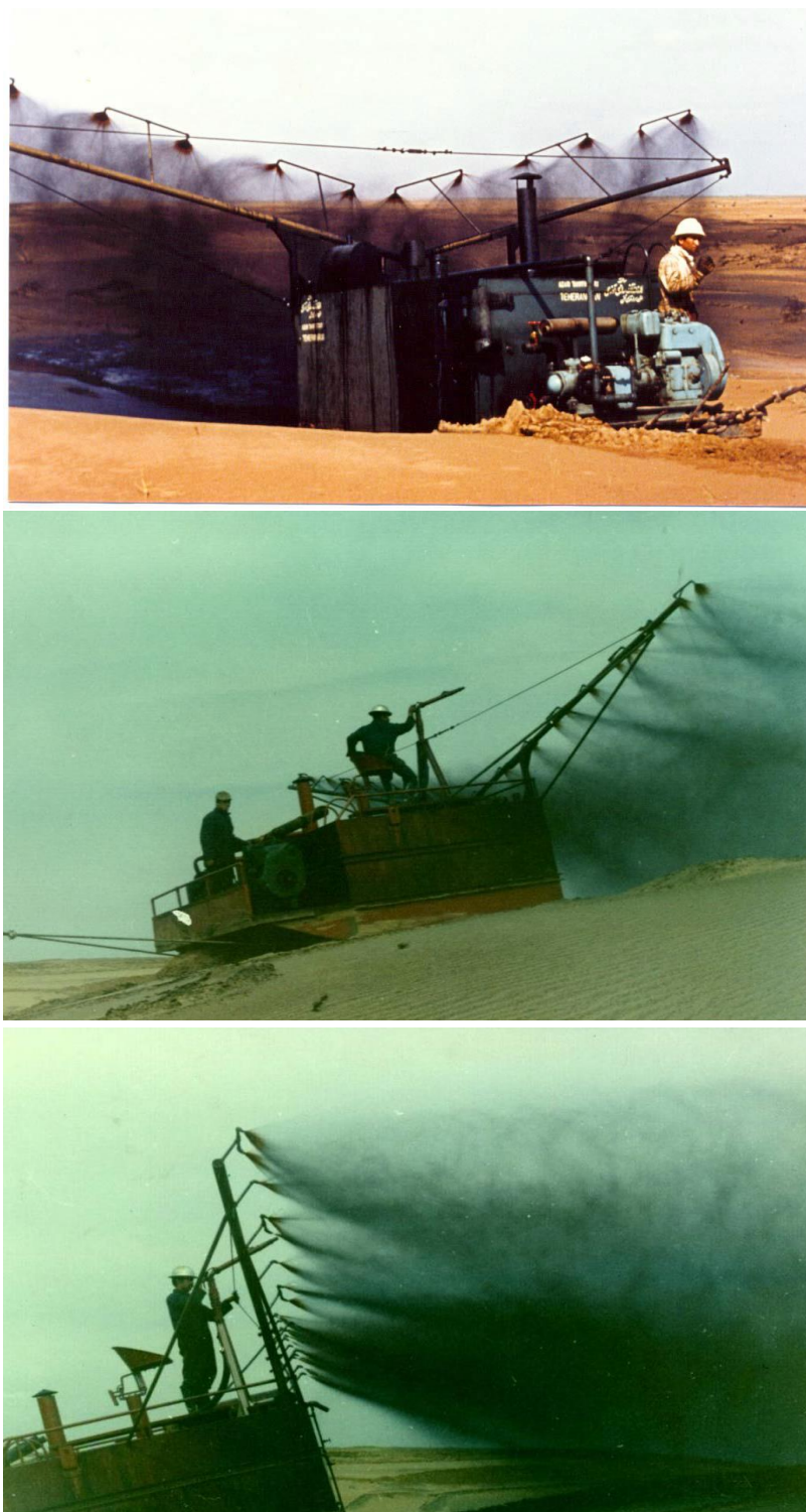
شکل ۲-۲۴- اسکی مجهز به آنتن مالچ پاش
