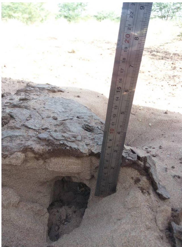
شکل ۲-۸- ضخامت لایه مالچ ایجاد شده بر روی خاک
