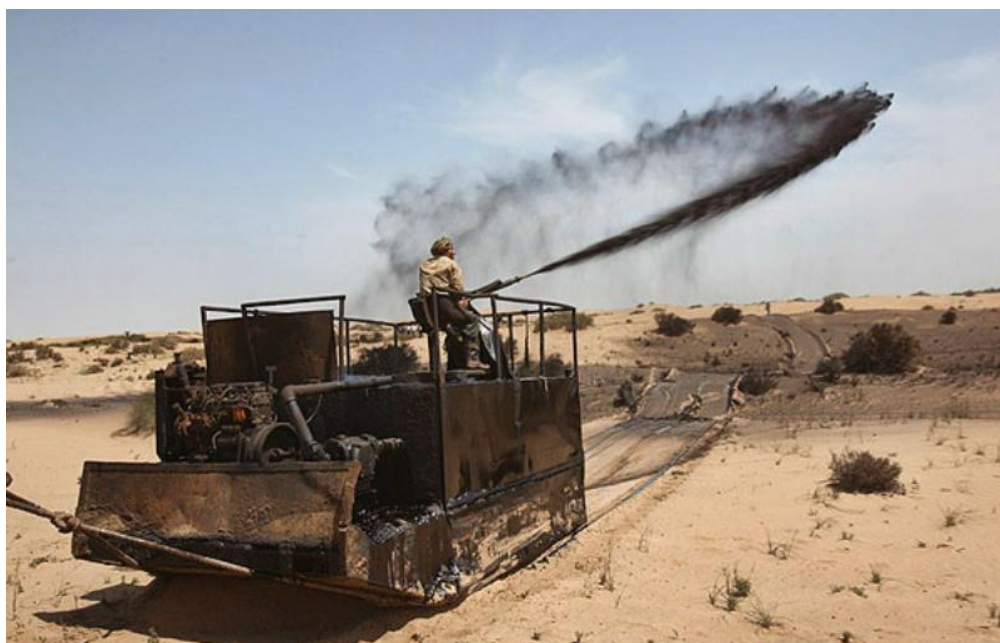
شکل ۲-۲۵- استفاده از گان برای مالچ پاشی می تواند مشکلات ناشی از تغییر سرعت دستگاه های کشنده را تعدیل نماید. در این زمینه مهارت فرد مالچ پاش «گان زن» دارای تأثیر زیادی است.
