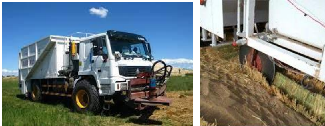
شکل ۱-۴۹- نمایش از دستگاه استقرار بادشکن مکانیکی (پوشال گیاهی)
